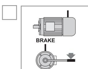
Редукторы не являются самоотключающимися устройствами. Для обеспечения данной функции необходимо использовать независимый блокиратор. Не следует использовать редукторы в качестве тормозного механизма. Нагрузки на редуктор не должны превышать указанных в данном каталоге.
