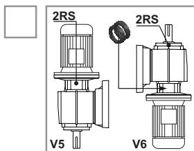
Отметьте, если редуктор будет использоваться в монтажных позициях V5 и V6. Будут установлены самосмазывающиеся подшипники 2RS (см. рисунок). Для монтажной позиции V6 мы рекомендуем использовать двойные входные сальники. Монтажная позиция V6 не рекомендуется для двухполюсных двигателей.
