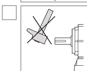
При установке элементов на вал редуктора следует избегать толчков и ударов, используя соответствующие съемники, которые крепятся с помощью резьбовых отверстий на торцах валов.
