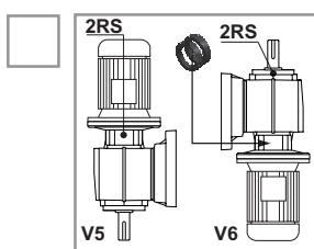
Не изменяйте монтажную позицию без разрешения производителя. Для изменения монтажной позиции может потребоваться определенный тип смазки. Если редукторы, установленные в монтажные позиции V5 или V6, эксплуатируются в непрерывном режиме, необходимо заменить верхний подшипник на самосмазывающийся подшипник. Для монтажной позиции типа V6 рекомендуется использовать двойной входной сальник.
