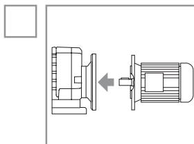
При монтаже двигателя на редуктор крепежные болты следует затягивать при соприкосновении поверхности двигателя с фланцем редуктора. После завершения сборки убедитесь в беспрепятственном вращении мотор-редуктора, повернув крыльчатку мотора рукой.
