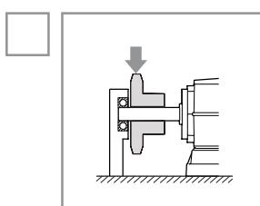
Для предотвращения преждевременного износа подшипника и поломки вала при большой радиальной нагрузке требуется дополнительная опора.
