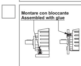
Если устройство эксплуатируется с частыми пусками, остановками и реверсированием хода, в качестве крепежных элементов следует использовать болты Loctite код 270 или подобные.
