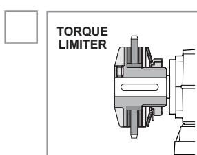
Если механизм эксплуатируется с большими ударными нагрузками и резкими остановками, рекомендуется использовать механические или электронные ограничители крутящего момента.
