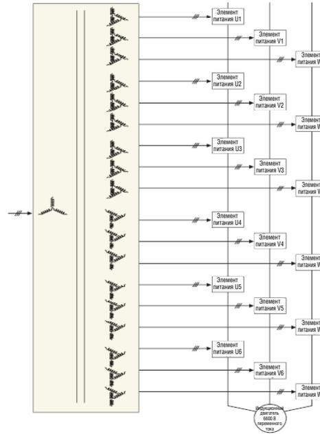
Инвертор однофазного элемента питания (Элемент питания)
