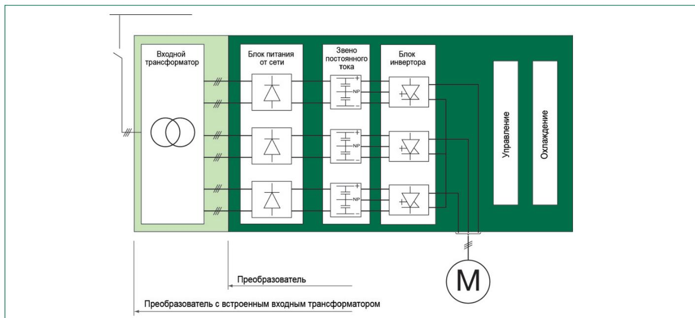
ACS 5000 - топология многоуровневого инвертора напряжения, не содержащего предохранителей
